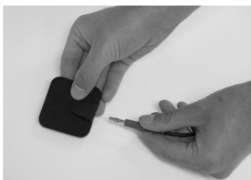
Rysunek 6-2. Sposób podłączania elektrod
